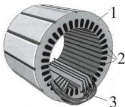
Фиг. 10 Статор на асинхронен електрически двигател 1 - статор; 2 - канали на статорна намотка; 3 - част от статорна намотка.
