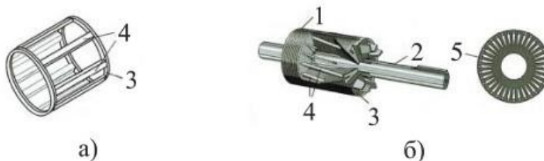
Фиг. 11 Накъсо съединен ротор на асинхронен електрически двигател а) - схема; б) - устройство
